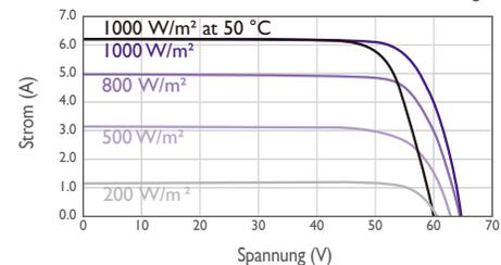
Strom-Spannungs-Kennlinie in Abhängigkeit von Strahlungsstärke und Temperatur des Moduls.
