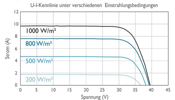
Strom-Spannungs-Kennlinie in Abhängigkeit von Strahlungsstärke und Temperatur des Moduls.
