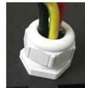
6. Oberhalb der linken PG Verschraubung das rote (+) und schwarze (-) Kabel durch den mitgelieferten Klappferrit **G** führen.
