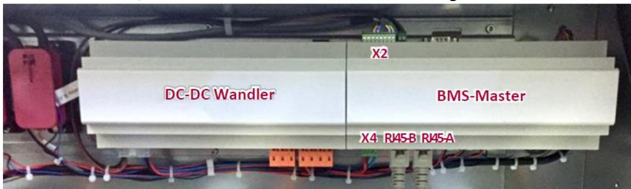
Abbildung 9: Anordnung BMS-Master, DC-DC Wandler, Relais und Vorladewiderstand
