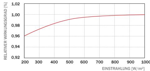
Die typische relative Änderung des Modulwirkungsgrades bezogen auf die Nennleistung bei einer Einstrahlung von 200 W/m<sup>2</sup> im Verhältnis zu 1000 W/m<sup>2</sup> beträgt -4% rel. (gemessen bei 25 °C, AM 1,5 G Spektrum).
