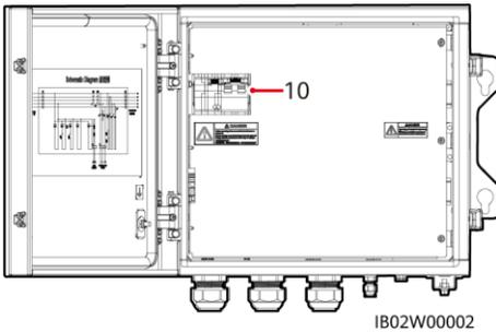
(10) Schalter für netzentkoppelte Last
