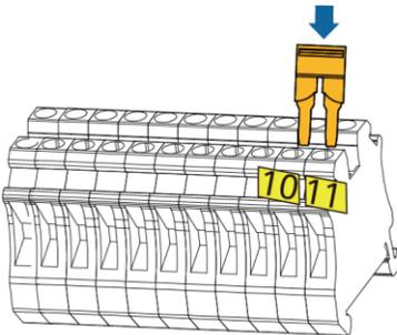
Wechselrichter-AC-Klemme X3 (einphasig)
