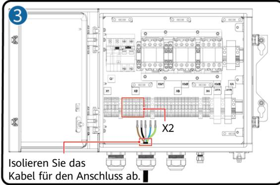
Isolieren Sie das Kabel für den Anschluss ab.
