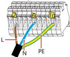
Klemme auf Wechselrichterseite (einphasig)
