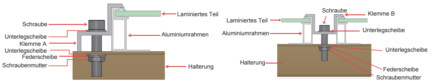
Abbildung 5 Klemminstallation des Monofacial-Moduls
