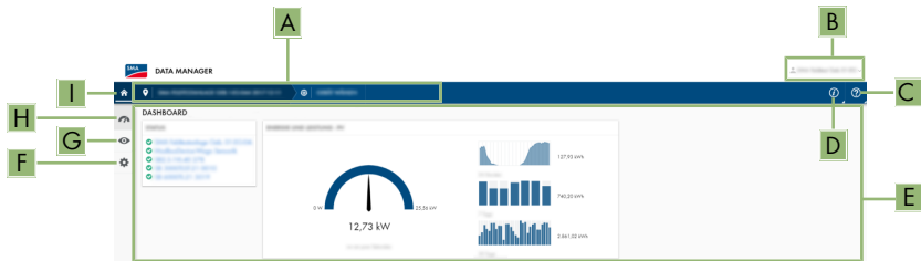
Abbildung 9: Aufbau der Benutzeroberfläche (Beispiel)
