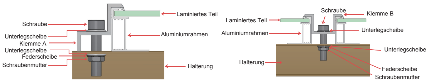
Abbildung 5 Klemminstallation des Monofacial-Moduls
