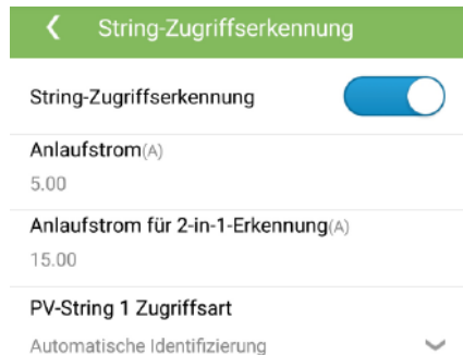
Abbildung 7-11 Zugangserkennung des PV-Strings
