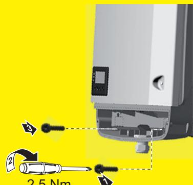
Falownik należy zawsze przykręcać do uchwytu ściennego za pomocą śrub mocujących przy użyciu momentu obrotowego podanego w instrukcji obsługi. Falownik uruchamiać wyłącznie z dokreconymi śrubami mocującymi.
