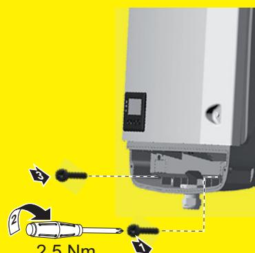
As especificações do fabricante para conexão, instalação e operação devem ser observadas. Siga cuidadosamente todas as instalações e as conexões das diretrizes e regulagens para reduzir o potencial de riscos a um mínimo. Os torques dos respectivos locais de conexão são obtidos no manual de instruções / manual de instalação do aparelho.
