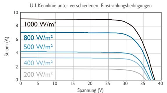
Strom-Spannungs-Kennlinie in Abhängigkeit von Strahlungsstärke und Temperatur des Moduls.
