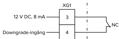
Fig. 11: Principkopplingschema: anslutning av en extern brytarkontakt
