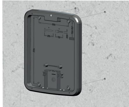
4. Bohren Sie die angezeichneten Montagelöcher (Ø 10 mm). Sofern notwendig setzen Sie die mitgelieferten Dübel für die Befestigungsschrauben ein.
