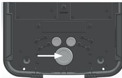
10. Hängen Sie die Wallbox an der Montageplatte an. Führen Sie dazu die zentral im oberen Bereich auf der Rückseite eingedrehte Schraube in die entsprechende Öffnung auf der Montageplatte ein: Die Wallbox ist nun bereits fall-sicher befestigt.
