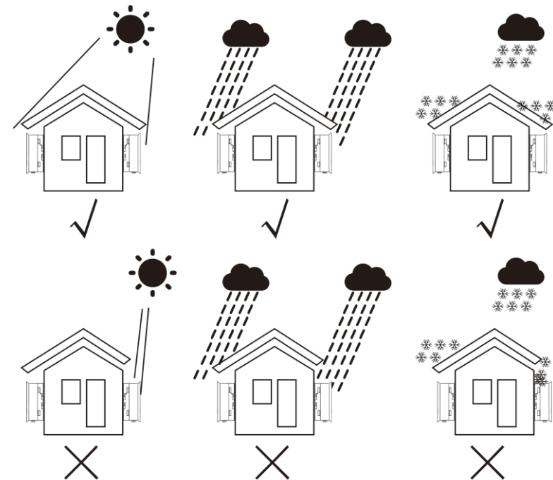
▲ Abbildung 4.1 Empfohlene Installationsorte
