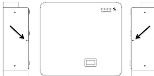
Abb. 6: Position der Sicherungsschrauben
