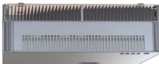
Abb. 53: Kühler-Lamellen und Luftaustritt oben
