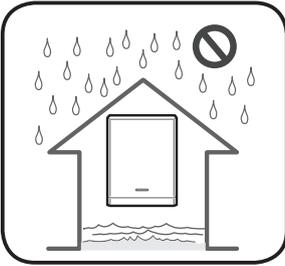
Das Produkt nicht an einem Ort installieren, an dem es häufig zu Überflutungen kommt.
