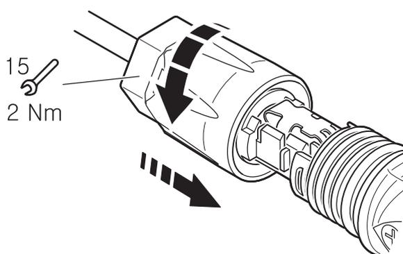
Den Einsatz in die Hülse einsetzen und die Kabelverschraubung mit einem 15 mm Schraubenschlüssel am Gehäuse befestigen. (2 N.m)
