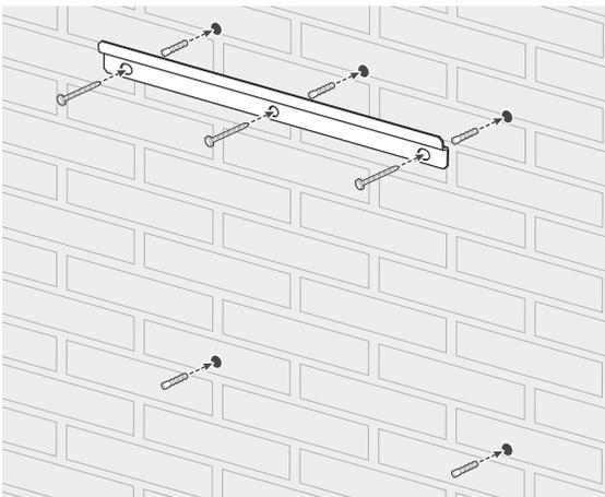
Die Wandhalterung mit Dübel und Schrauben befestigen.
