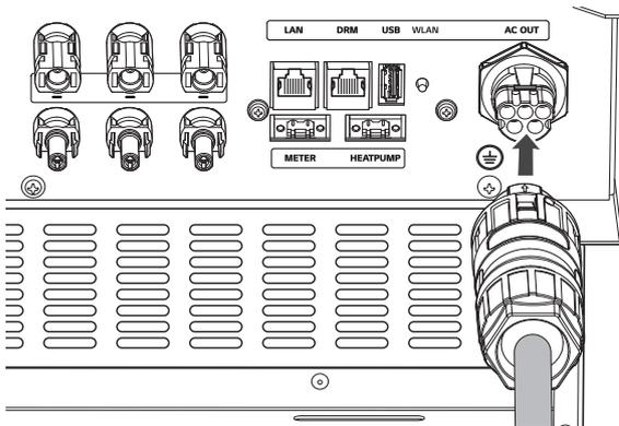
Unten beim Produkt den AC-Kabelstecker-Netz am Stecker für das AC-Kabel anschließen.
