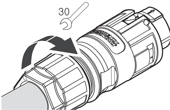
Die Gummidichtung ins Gehäuse setzen und die Kabelverschraubung am Gehäuse festmachen, dazu einen 30-mm-Schraubenschlüssel benutzen. (4,5 N.m)
