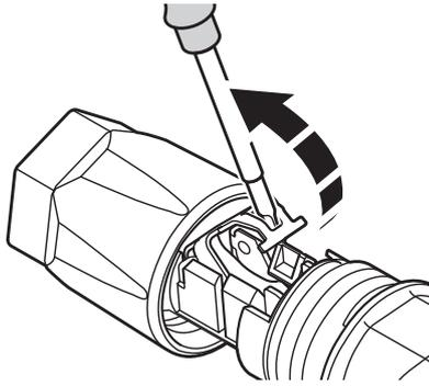
Mit einem Schraubendreher die Federklemme öffnen.
