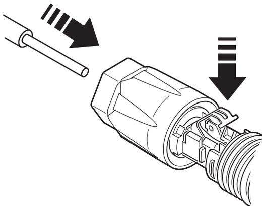
Vorsichtig die abisolierten Kabelenden in den entsprechenden Kabel-Konnektor einführen. Die Drahtenden müssen in der Feder sichtbar sein.
