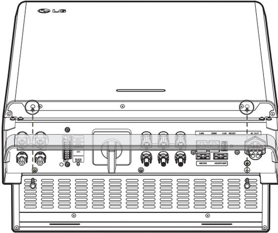
Nach Durchführung aller elektrischen Anschlüsse die untere Abdeckung anbringen und mit den Schrauben befestigen - siehe Abbildung.
