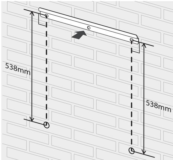
Die Wandhalterung in der Weise an einer Wand ansetzen, dass die Installationsvoraussetzungen und die erforderlichen Zwischenräume eingehalten werden können.
