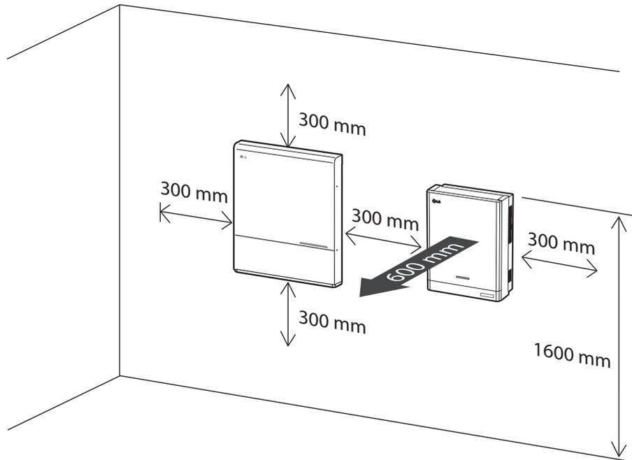
Dieses Produkt muss so installiert werden, dass links, rechts, oben, unten und vorne die gebotenen Zwischenräume eingehalten werden - siehe Abbildung.
