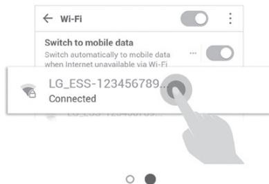
Drücken Sie die WLAN-Taste an der Unterseite des ESS und gehen Sie zum Menü Einstellungen> WLAN und wählen Sie ESS, um eine Verbindung herzustellen. Das ESS WLAN-Passwort finden Sie auf der rechten Seite des ESS-Geräts unter WLAN-Passwort.
