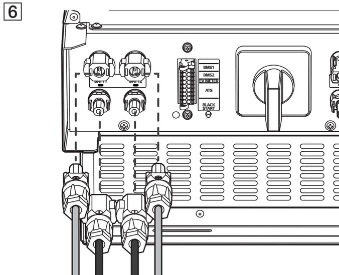
Unten am Produkt beide Stecker des Akku-Kabels an die Konnektoren des DC-Kabels anschließen.
