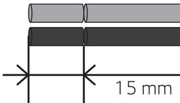
Die +- und -Drähte des Akkukabels um 15 mm abisolieren - siehe Abbildung.
