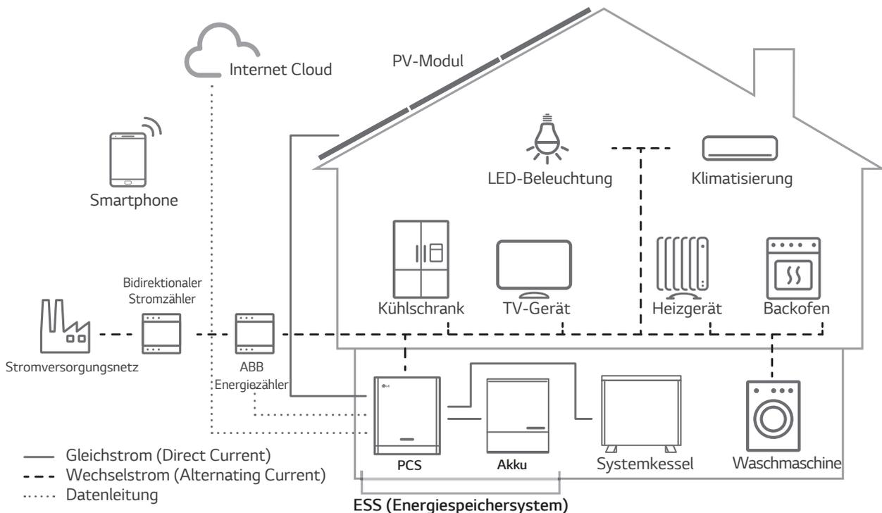
Die von einer PV-String erzeugte Elektrizität kann im angeschlossenen Akku gespeichert oder an ein Energieversorgungsunternehmen verkauft werden.
