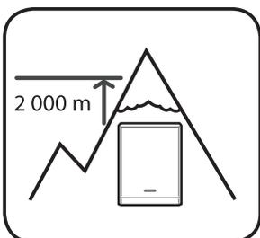
Dieses Produkt darf nicht installiert oder betrieben werden an Orten, die über 2000 m über dem Meeresspiegel liegen.
