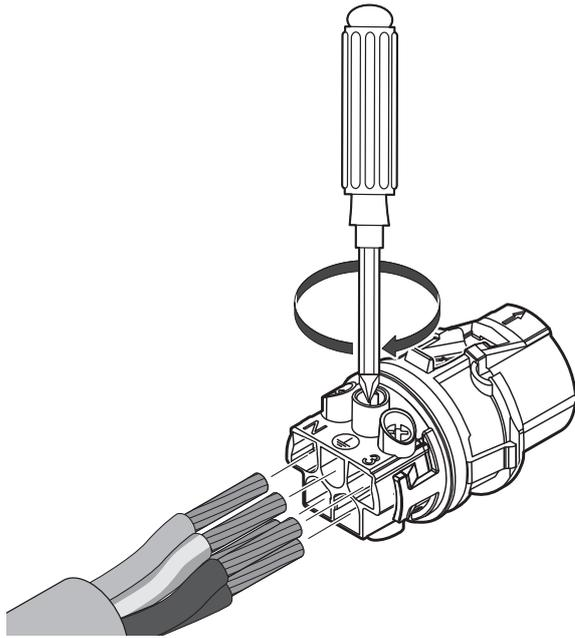
Die Drähte in die entsprechenden Löcher der Kontaktträger einführen und anschließen.
