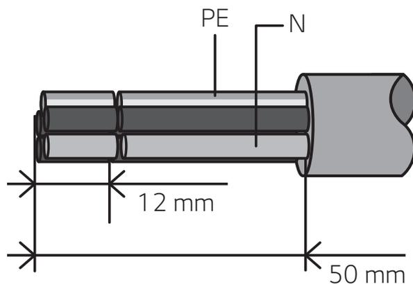
Die Enden des AC-Kabels abisolieren - siehe Abbildung.
