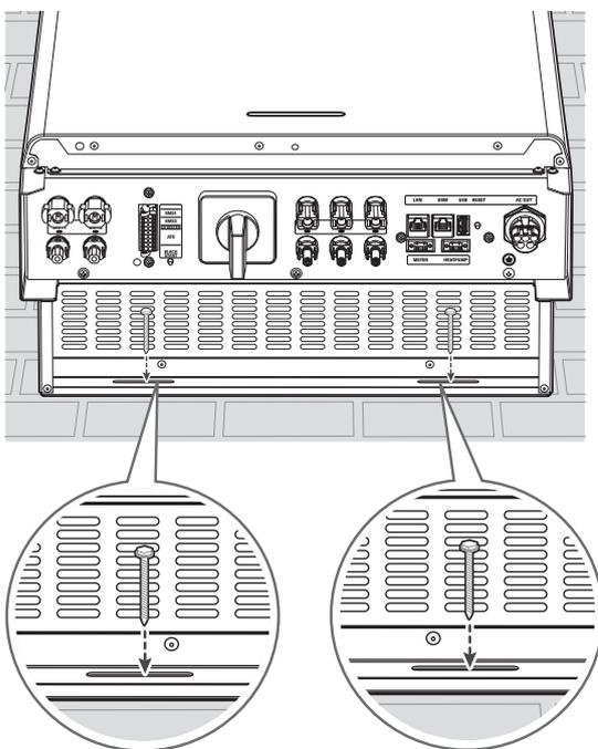
An den Stellen der Schraubenlöcher die Löcher bohren und das Produkt mit Dübel und Schrauben an der Wand befestigen.
