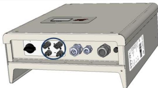
Stellen Sie sicher, dass der DC-Schalter auf "0" steht, dann stecken Sie die entsprechenden Plus- und Minuspole an die DC Eingänge des Wechselrichters an.
