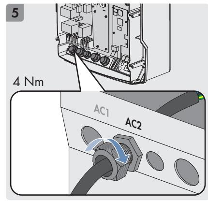
**en** Connecting the AC cable for the battery-backup system **de** AC-Kabel für Ersatzstromsystem anschließen
