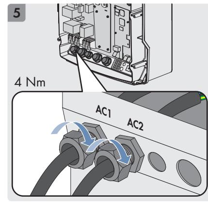
**en** Connecting the AC cable for the SMA Flexible Storage    **de** AC-Kabel für SMA Flexible Storage anschließen
