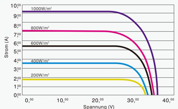
Hervorragende Leistung bei schwachen Lichtverhältnissen: Bei einer Strahlungsintensität von 200 W/m<sup>2</sup> W/m (AM 1,5, 25 °C), 96,5% oder mehr der STC Effizienz (1000 W/m<sup>2</sup>) wird erreicht
