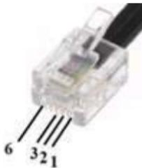
**Abbildung 28: Crimpen der Leitungen**
