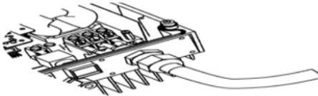
**Abbildung 12: Einführen des Kabels durch die AC-Kabelverschraubung – Einphasen-Wechselrichter**
