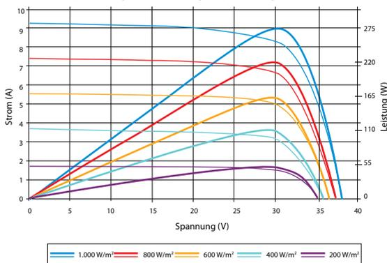
Hervorragende Leistung bei schwachem Licht: bei einer Strahlungsintensität von 200 W/m<sup>2</sup> (Luftmasse 1,5, 25 °C) ist ein relativer Modulwirkungsgrad von mehr als 96,5% gegenüber Standardtestbedingungen (1.000 W/m<sup>2</sup>) erreichbar.
