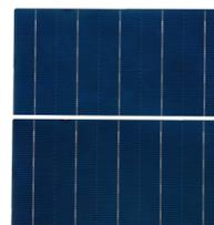
Halbe Zellen haben einen geringeren inneren Widerstand und einen geringeren Strom im Vergleich zu Zellen, welche nicht halbiert wurden. Sortiert man diese Halbzellen nach Ihren elektrischen Eigenschaften sorgfältig und verlötet man diese zu einem Modul resultiert eine höhere Modulleistung und homogenere Zelltemperatur und damit Zuverlässigkeit im Betrieb.
