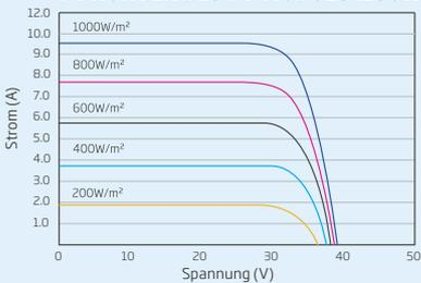
**P-V KURVEN DES PV-MODULS (290W)**
