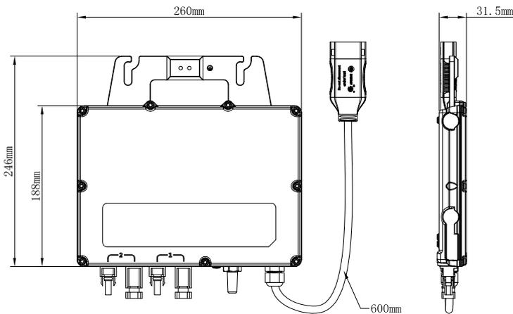
Der APsystems YC 600 ist ein netzgekoppelter Mikrowechselrichter mit Vernetzung zu einem intelligenten Überwachungssystem und einem sehr hohen Wirkungsgrad. Der hoher Wirkungsgrad und die hohe Zuverlässigkeit des YC 600 kennzeichnet sich durch zwei unabhängige MPPT-Eingänge und eine maximale Ausgangsleistung bis 600 W.
