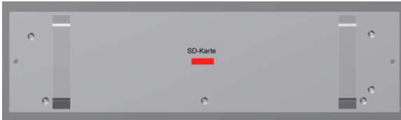
Abbildung 24: Position der SD-Karte
