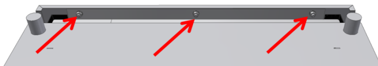
Abbildung 32: Muttern Schrankdeckel – (hinten-unten)
